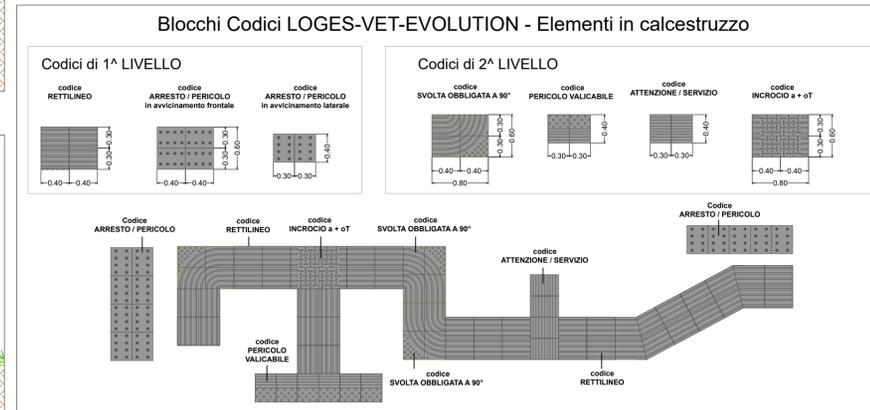
Schema tipo di funzionamento dei pavimenti podo-tattili per non e ipo vedenti \_ scala 1:50
